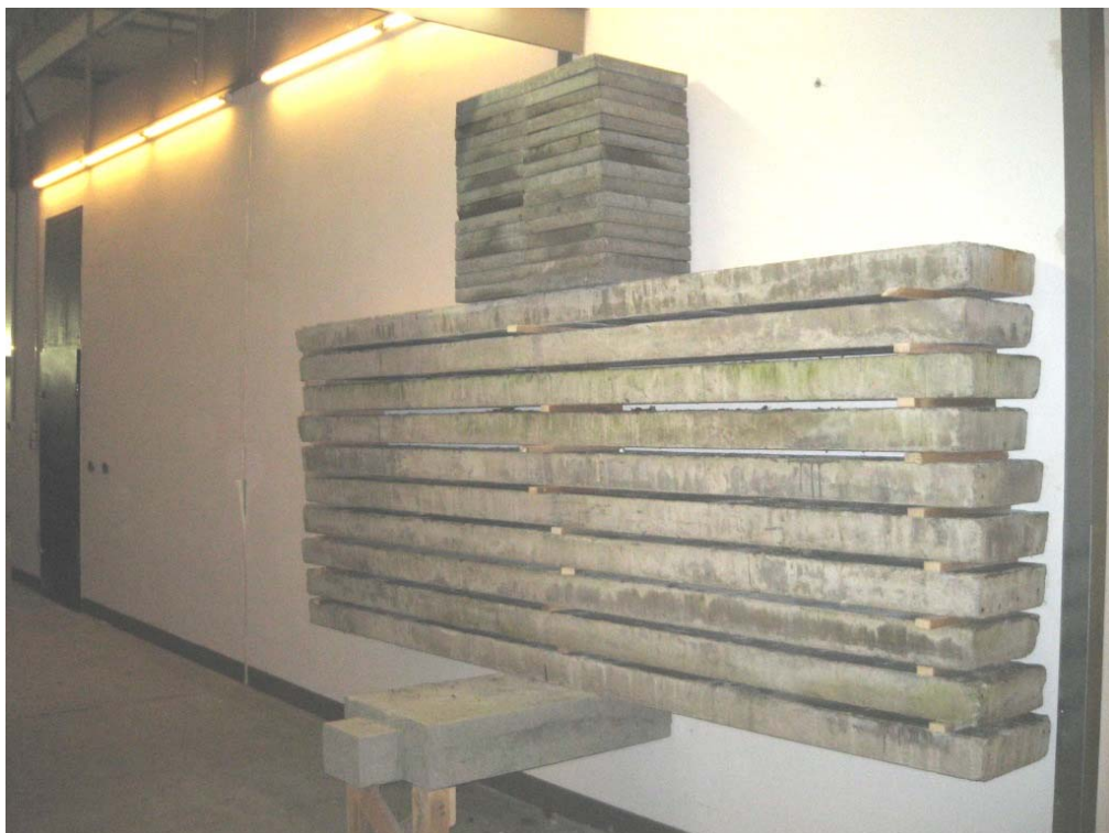
Bild 8: Prüfaufbau 1, Laststufe 28,54 kN, entkoppelter Einbau mit Egcotritt
