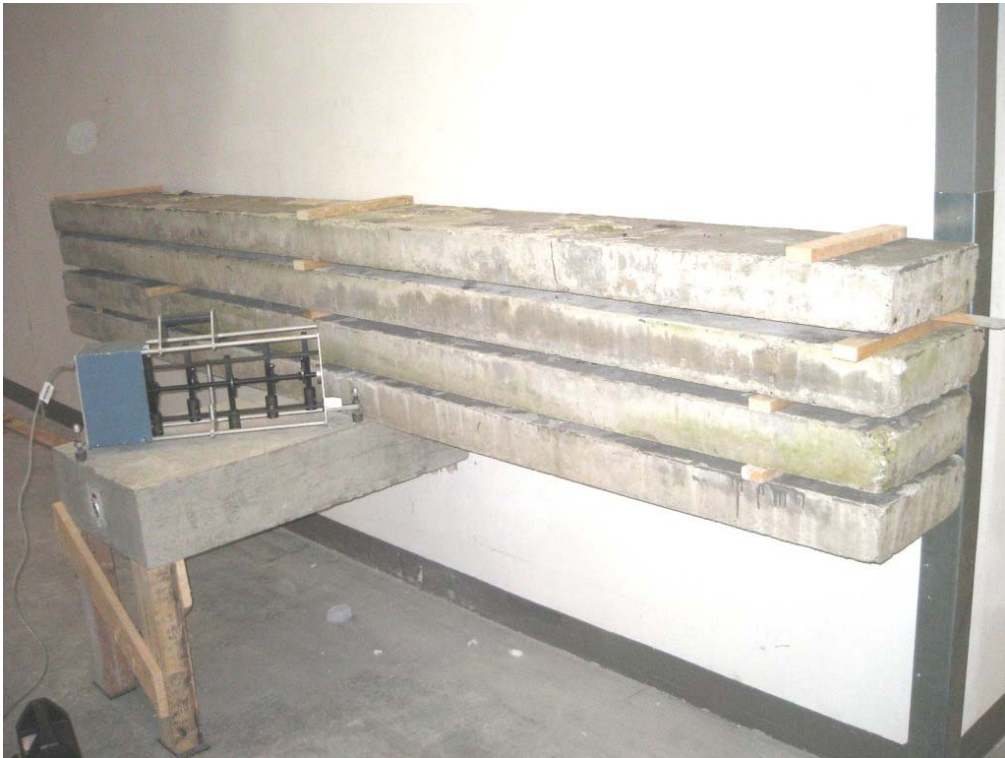
Bild 1: Prüfaufbau 1, Laststufe 10,29 kN, starrer Einbau
