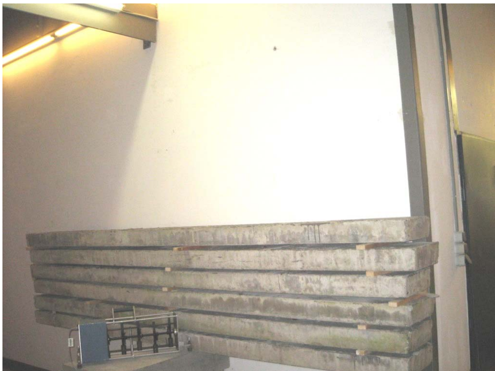
Bild 4: Prüfaufbau 1, Laststufe 14,85 kN, entkoppelter Einbau mit Egcotritt
