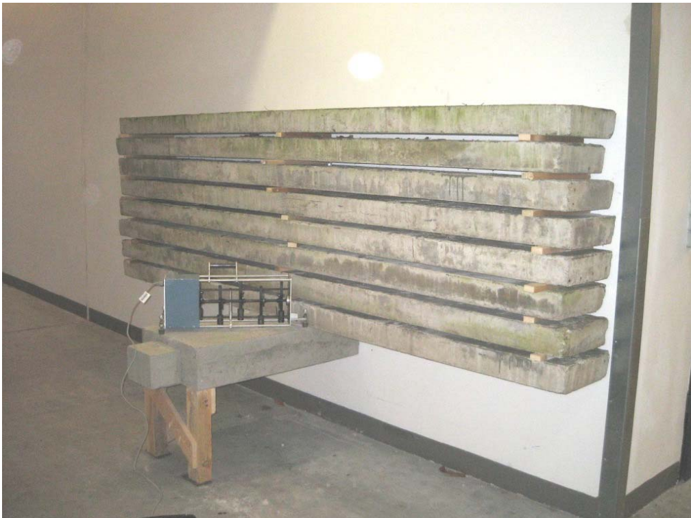
Bild 6: Prüfaufbau 1, Laststufe 19,42 kN, entkoppelter Einbau mit Egcotritt
