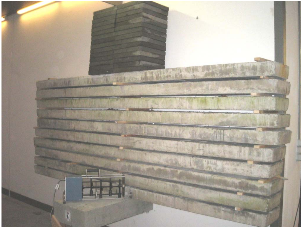
Bild 7: Prüfaufbau 1, Laststufe 28,54 kN, starrer Einbau
