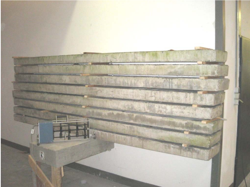
Bild 5: Prüfaufbau 1, Laststufe 19,42 kN, starrer Einbau
