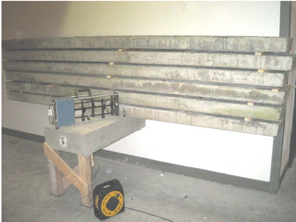
Bild 3: Prüfaufbau 1, Laststufe 14,85 kN, starrer Einbau
