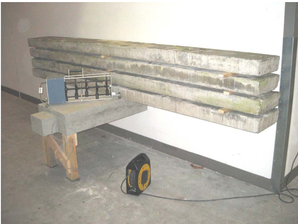
Bild 2: Prüfaufbau 1, Laststufe 10,29 kN, entkoppelter Einbau mit Egcotritt
